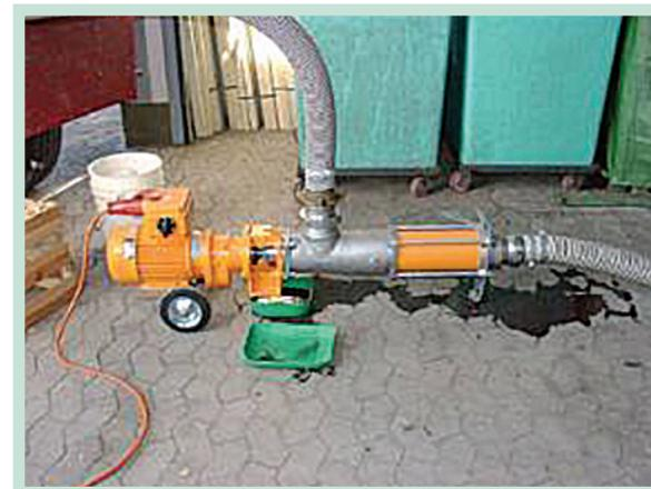
Fig. 63: Pompe à moût transférant le moût fermenté à la presse.
