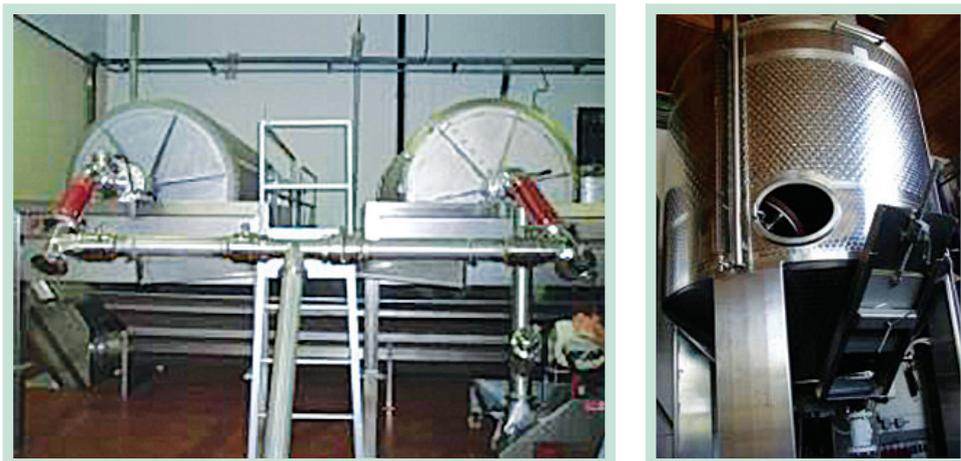
Fig. 69: Vins rouges - Cuves de macération: cuve rotative (gauche); cuve à immersion en inox (droite)
