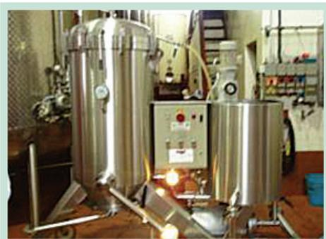
Fig. 51: Filtre de cellulose ou kieselgur
