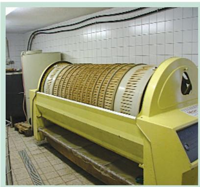
Fig. 40: Pressoir horizontal à vis
