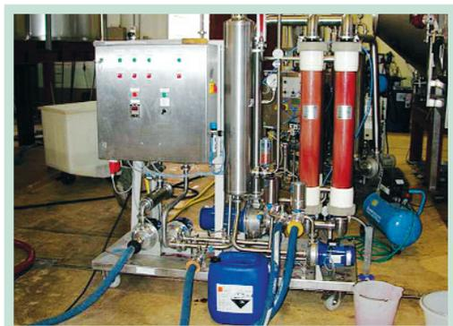
Fig. 78: Filtration stérile: filtre à membrane
